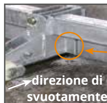
arresto lama raschiatrice: nessun contatto con il pavimento
