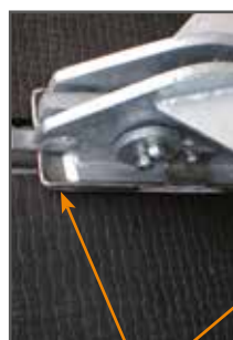
ampio appoggio per il blocco centrale, piegato in alto a forma di slitta all'estremità
