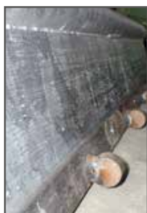
ferri tondi saldati sulla lama
