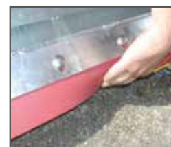
Una striscia in gomma montata sulle lame raschiatrici migliora la rimozione del letame. L'impiego su gomma non dà problemi.
