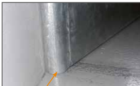
lame di raschiamento laterali Attenzione: spigoli vivi! (-> arrotondare!)
