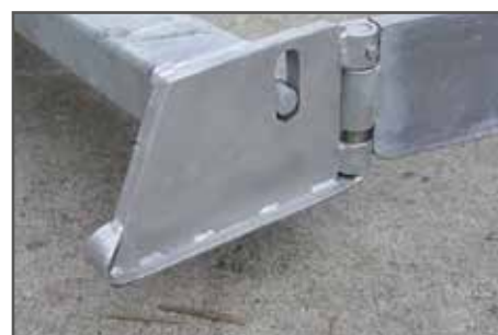
pattino laterale largo e piegato in alto a forma di slitta
